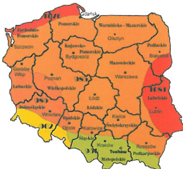
Rysunek 5. Rejonizacja średniorocznych sum promieniowania słonecznego całkowitego padającego na jednostkę powierzchni poziomej w kWh/m 2 /rok. Liczby wskazują całkowite zasoby energii promieniowania słonecznego w ciągu roku dla wskazanych rejonów kraju (źródło: Instytut Meteorologii i Gospodarki Wodnej)
