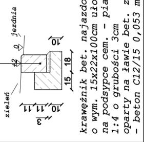
krawężnik bet. najazdowy o wym. 15x22x100cm ułożony na podsypce cem. - piaskowej 1:4 o grubości 3cm oparty na ławie bet. z oporem - beton C12/15 0,053 m<sup>3</sup>/mb
