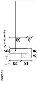
obrzeże bet. o wym 8x30x100cm ułożone na ławie bet. z oporem - beton C12/15 0,021m<sup>3</sup>/mb
